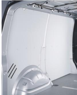
Konturgefräste Wandverkleidung aus recyclingfähigem Polypropylen
