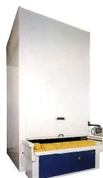
Diese Magazine eignen sich vor allem zur Lagerung von Kleinteilen auf engstem Raum und ermöglichen einen schnellen Zugriff. Das System besteht aus einem verkleideten Turm in dem mehrere Wannen für die Waren eingebaut sind. Ein mobiler vertikaler Aufzug ermöglicht die Bewegung der Wannen so, dass die ausgewählte Wanne zur Ausgabe kommt.
